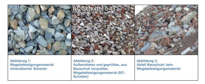
Material aus Häuserabbruch, Dachziegeln oder Asphaltfräsgut (Abbildung 3) ist ohne weitere Aufbereitung zur Wegebefestigung technisch ungeeignet. Aufgrund seiner oft ungeklärten Herkunft kann dieser Abfall zudem eine Vielzahl von Schadstoffen aufweisen. Bei Verwertung zur Wegebefestigung kann damit eine Schädigung des Bodens, des Grundwassers und damit auch des Trinkwassers verursacht werden. Eine falsch verstandene Recyclingabsicht kann bei diesen Stoffen zu beträchtlichen Umweltschäden führen.
